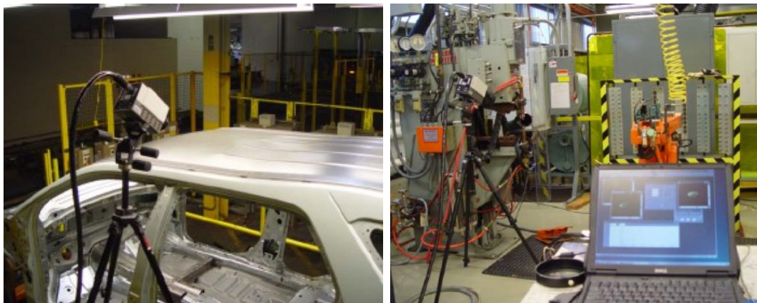
Fig. 9.25 Controlul cu IR în procesul de fabricație[102].
