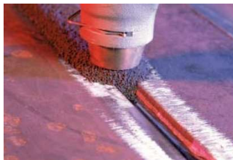
Fig. 4.17 Sudarea sub strat de flux.
