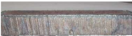
a) Suprafețe de tăiere normale, perpendiculare, netede, fără zgură aderentă, rizuri de tăiere uniforme.
