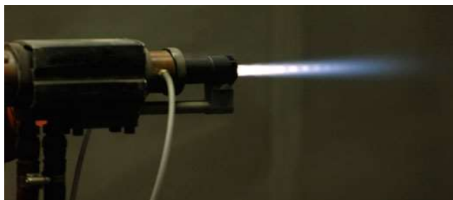
Fig.8.48 Pulverizarea cu flacără HVOF (high velocity oxygen fuel).
