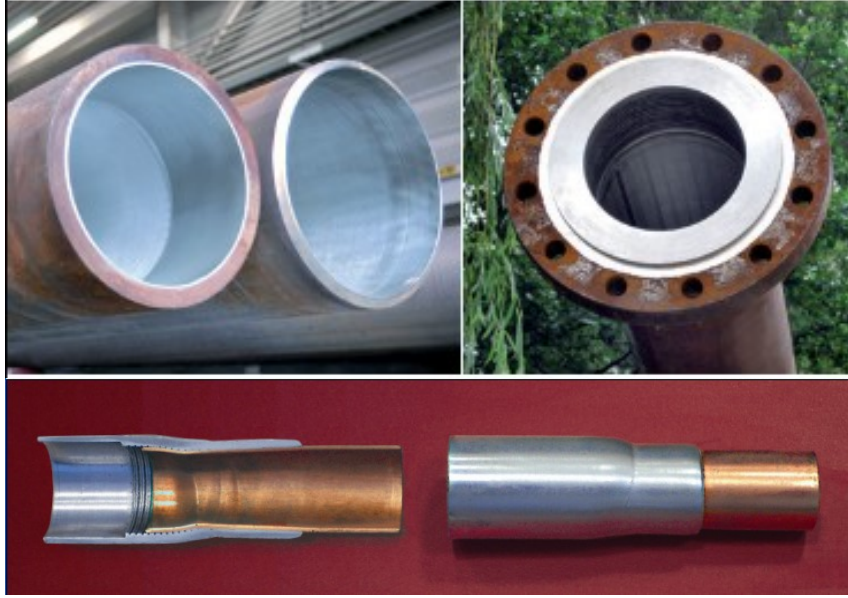
Fig. 5.47 Sudarea cu impuls electromagnetic a profilelor tubulare [59].
