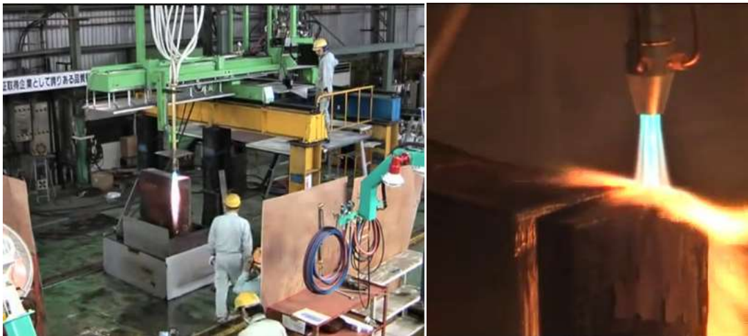
Fig. 8.11 Tăierea oxiacetilenică a unui bloc de oțel carbon, cu grosime de 850 mm. Sanso Kogyo Co. Ltd. Japan.
