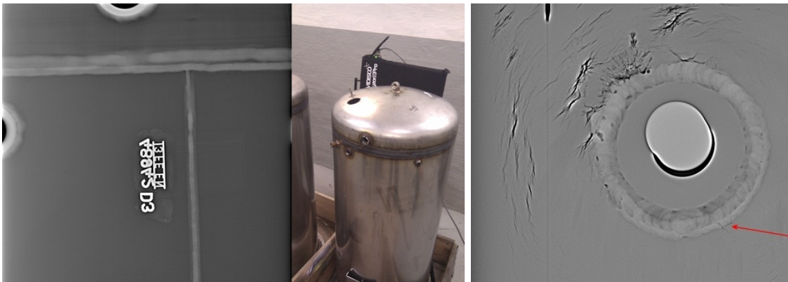
Fig. 9.61 Fisuri vizibile la examinare RT-D a unui cazan sub presiune, Vidisco [113].
