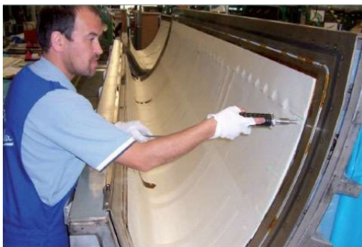
Fig. 5.35 Sudarea cu ultrasunete a unei aripi de avion Airbus A380. Fokker Aerostructures [50]
