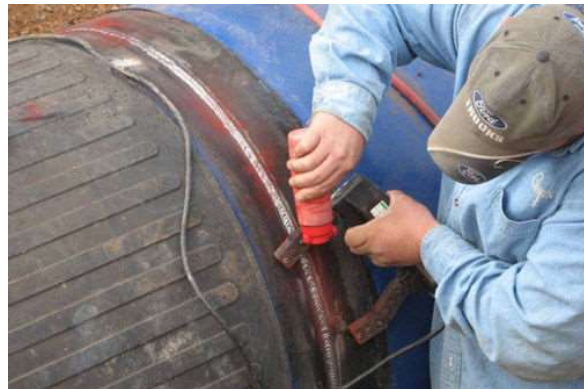
Fig. 9.17 Examinare cu pulberi magnetice colorate prin magnetizare polară.
