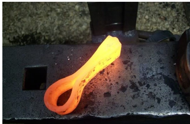
Fig. 5.43 Confecționarea securii prin sudare prin forjare.
