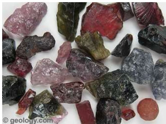
Fig. 8.28 Aspectul morfologic al particulelor abrazive garnet, X_3Y_2(SiO_4)_3 .
