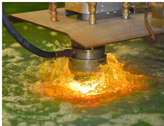
Fig. 8.24 Tăierea cu arc de plasmă sub apă și insuflare de aer, Hypertherm 2 [65].
