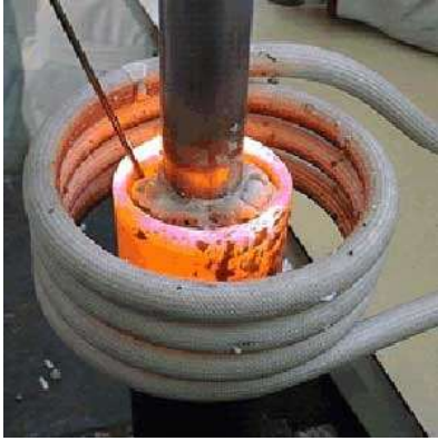
Fig. 8.38 Aspecte din procesul de brazare prin inducție.
