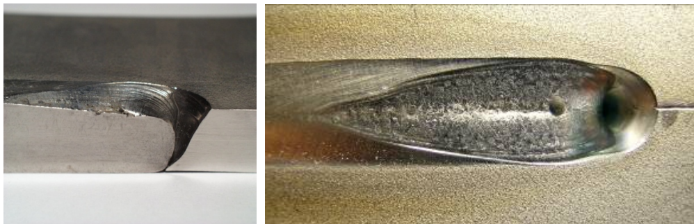
Fig. 4.71 Aspectul găurii de cheie la sudarea în arc de plasmă [29].
