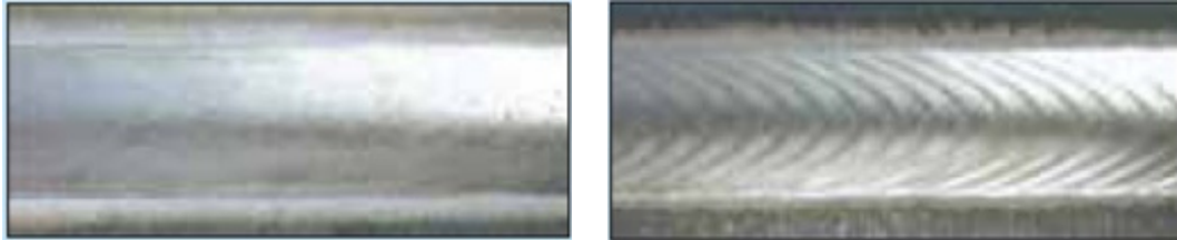
a) Sudare cu polaritate variabilă și curent modulat având formă de undă dreptunghiulară, f=200 Hz. b) Sudare cu polaritate variabilă și curent modulat având formă de undă dreptunghiulară, f=60 Hz. Fig. 4.61 Aspectul suprafeței cusăturii sudate în funcție de curentul de sudare, procedeul WIG [28].
