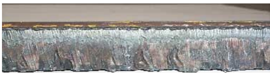
c) Distanță prea mare între duza de tăiere și piesă. Suprafața de tăiere neregulată, cu topirea muchiei superioare, rizuri adânci și neregulate în zona inferioară. Flacăra de preîncălzire nu este concentrată pe suprafața piesei, jetul de oxigen de tăiere nu este de formă cilindrică și este turbulent.
