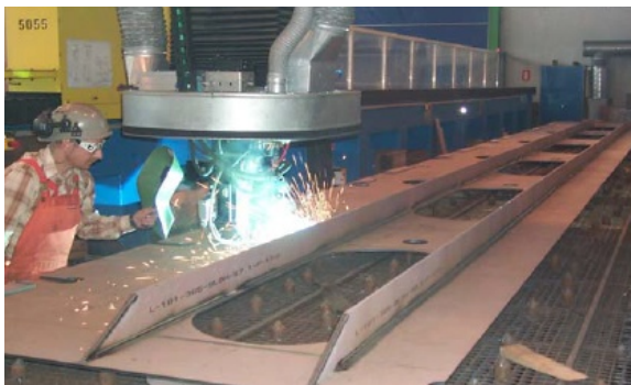
Fig. 4.90 Sudarea hibridă laser-MAG a panourilor de oțel, pe șantierul Odense Steel Shipyard [39].
