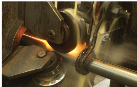
Fig. 5.21 Sudarea țevilor cu curenți de înaltă frecvență prin inducție.
