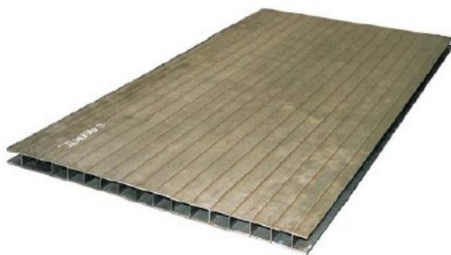
Fig. 4.92 Primele panouri sandwich sudate hibrid laser-MAG pe șantierul naval Meyer Werft - Germany cu instalații laser hibride cu o putere de 12 kW[39].
