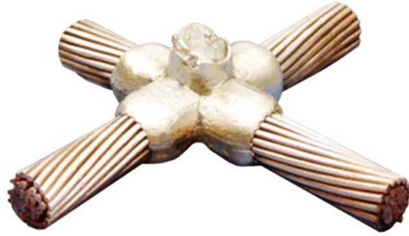
Fig. 4.94 Sudarea aluminotermică a cablurilor de aluminiu.
