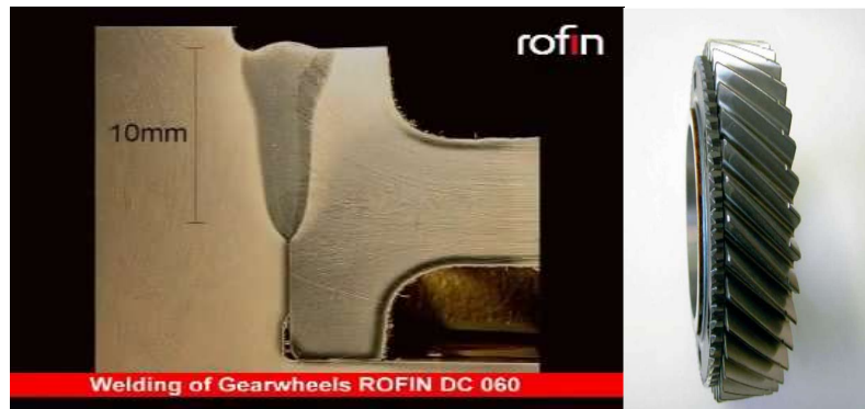
Fig. 4.85 Sudarea cu laser CO_2 a componentelor roților de transmisie dintr-o cutie de viteză [37].
