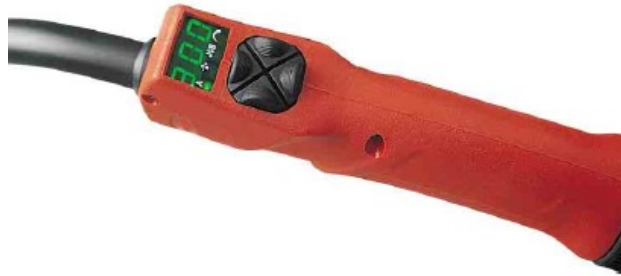
Fig. 4.50 Pistol de sudare cu display pentru controlul surselor de curent digitale [22].
