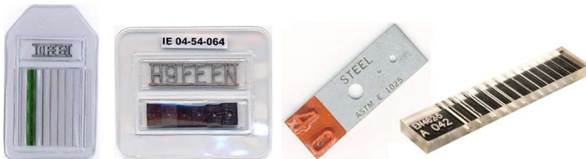
a) cu fire b) cu trepte și orificii c) cu găuri d) cu fire duplex
