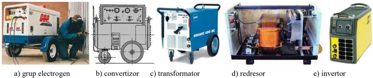
Fig. 4.10. Tipuri de surse de curent utilizate la sudarea cu electrod învelit.
