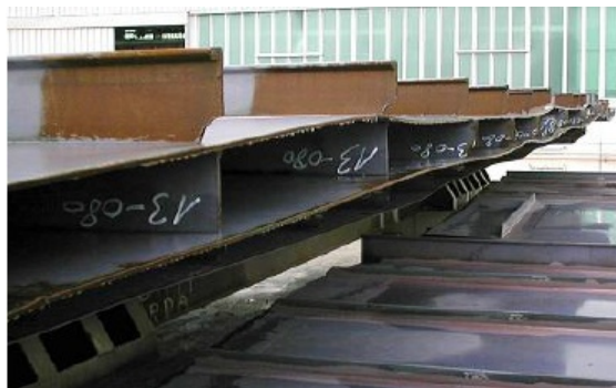
Fig. 4.91 Deformațiile panourilor sudate cu arc electric, GMAW[39].
