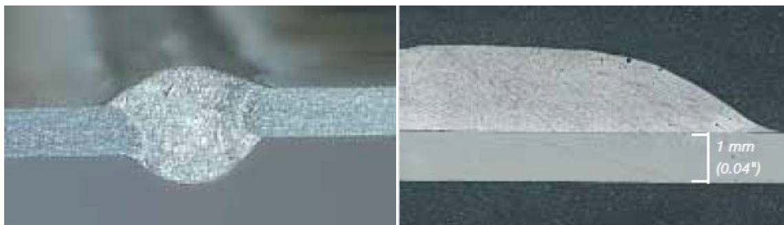
a) sudare CMT cap la cap fără susținere baie la rădăcină, tablă AlMg 3 de 0.3 mm grosime.
