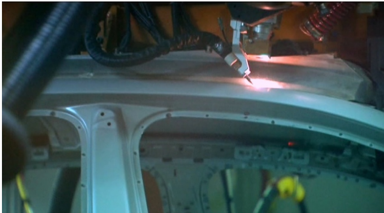
Fig. 4.89 Sudarea portierelor autoturismului VW Phaeton cu procedeul hibrid laser-MIG [36].
