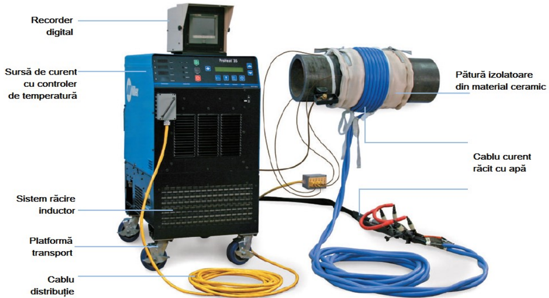
Fig. 6.10 Sistem industrial de preîncălzire sau tratamente termice post-sudare cu inducție [87].
