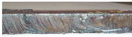
d) Debit de oxigen prea mare. Zgură excesivă aderentă la suprafețele de tăiere, întreruperi locale de tăiere, topirea excesivă a muchiei superioare. Se creează o turbulență între flacăra de preîncălzire și jetul de tăiere.
