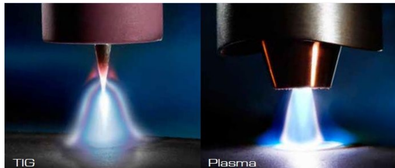
Fig. 4.69 Aspectul arcului de plasmă la sudarea WIG și cu plasmă.
