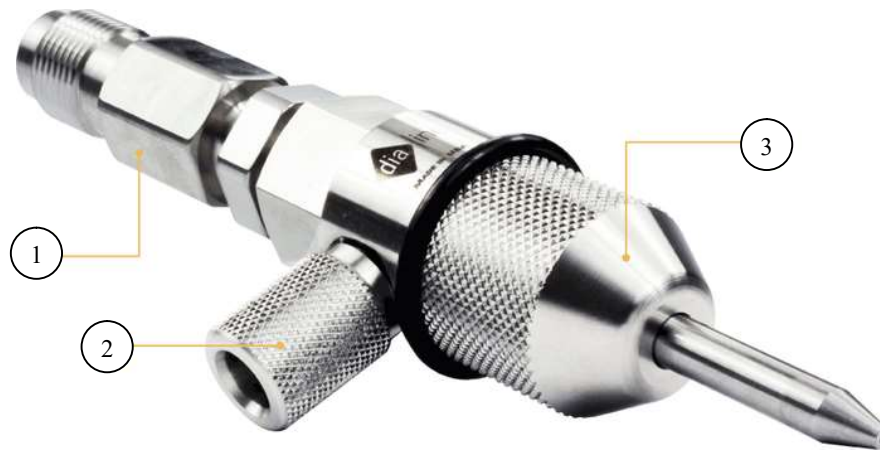
Fig. 8.27 Vedere generală a capului de tăiere cu jet de apă și particule abrazive [66]. 1- racord de apă, 2-intrare particule abrazive, 3-racord fixare tub ajutor
