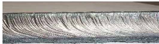
b) Viteză de tăiere mare, rizuri de tăiere adânci, curbate în direcția de avans, depuneri de zgură aderentă pe muchia inferioară. Debit de oxigen insuficient în jumătatea inferioară.
