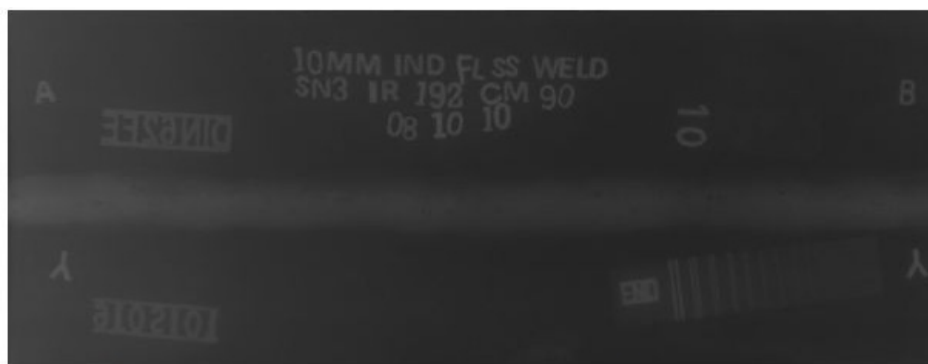
Placă de oțel cu grosime de 10 mm, sursă radioactivă Ir-192 și ecran fluoroscopic.
